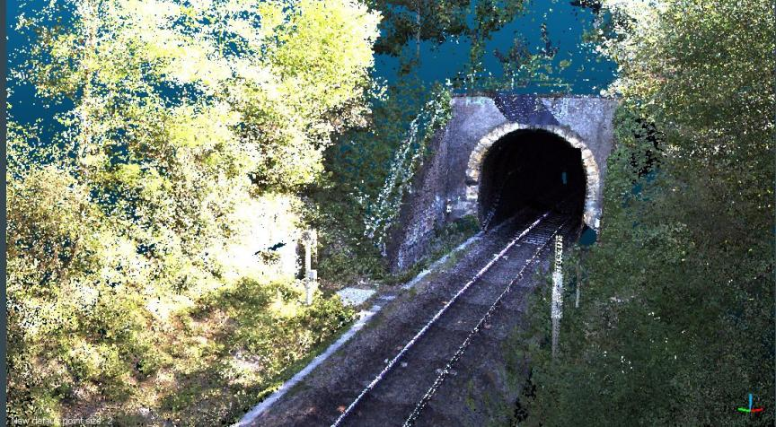
Assemblage des textures à partir des images panoramiques et du nuage de points 3D LiDAR
